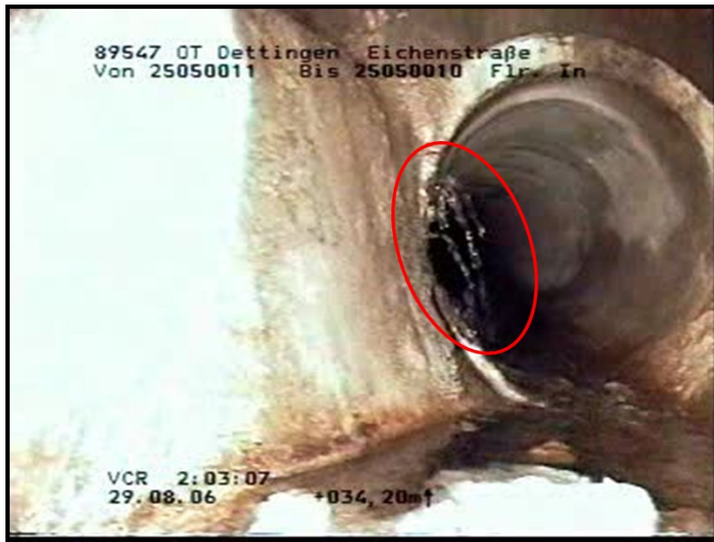
undichte Schachteinbindung SK 1, FW I
